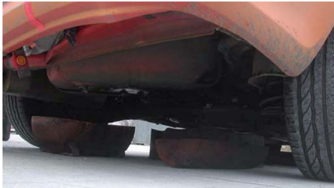
Figura 7: bandejas llenas de gasolina debajo del vehículo.
