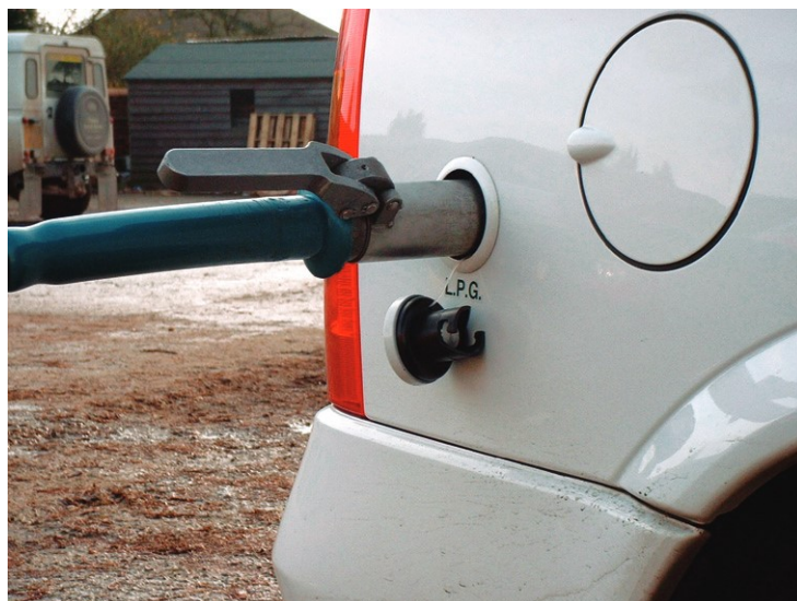
Repostaje de GLP
